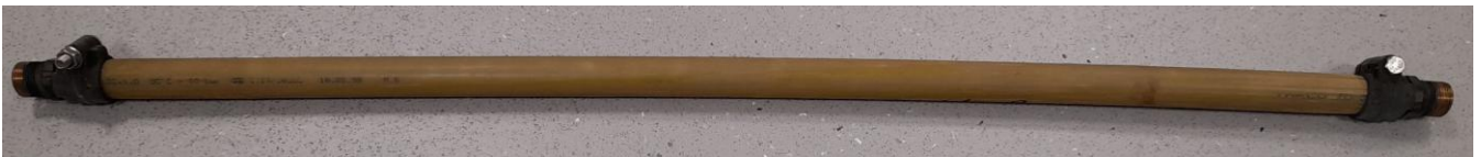
Figuur 2. De niet-gefaalde PEX buis na 1.000 uur in de hydrostatische druktest bij 95°C met een spanning van 4,6 MPa. De donkere verkleuring (vergelijk met figuur 6) is normaal na deze test.
